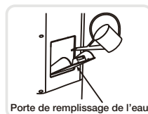
Porte de remplissage de l'eau
